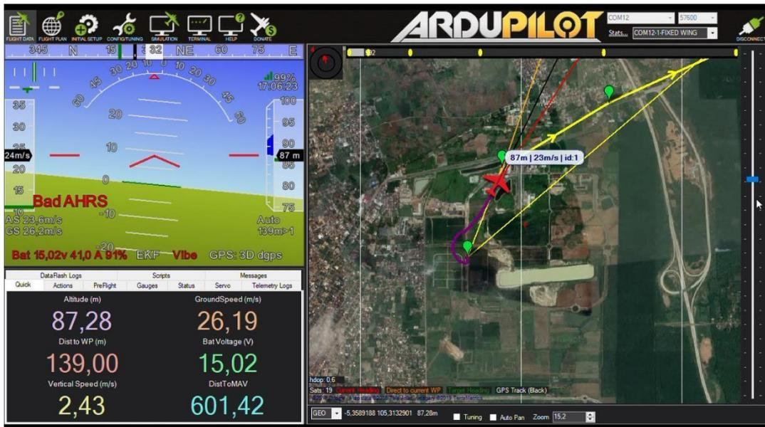
Gambar 4 Tampilan Software Mission Planner untuk UAV
