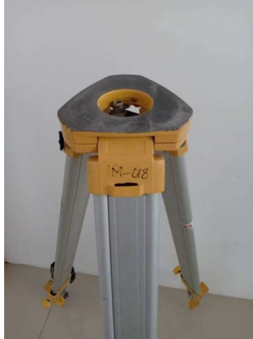
Gambar 3.3 Tripod sebagai penyangga total station
