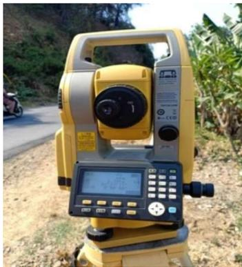
**Gambar 3.2** *Total station* untuk pengukuran topografi
