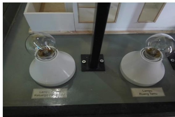
Gambar 4. 5. 2 Hasil Otomatisasi Pola Penjadwalan Diaktifkan (Jam 16.38 LRT dan LRK Mati Bersamaan)
