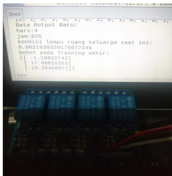
Gambar 4. 4. 2 Hasil Pengujian Ketika Output Kondisi Lampu LRT dan LRK Kurang dari 0,5
