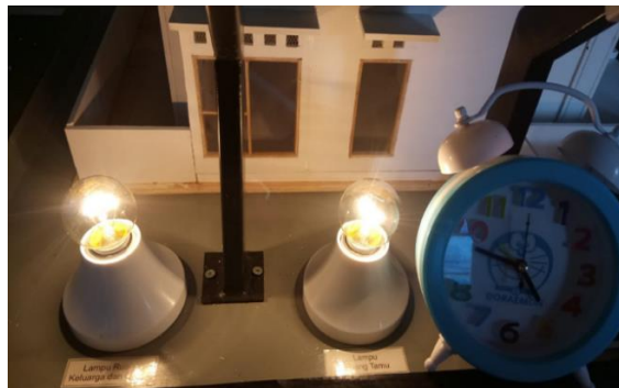
Gambar 4. 5. 1 Hasil Otomatisasi Pola Penjadwalan Diaktifkan (Jam 16.38 LRT dan LRK Hidup Bersamaan)
