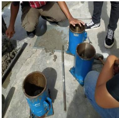
**Gambar 3. 10.** Pencetakan Beton
