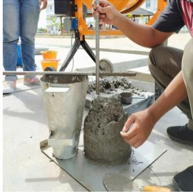
**Gambar 3. 9.** Pengujian *Slump Test*
