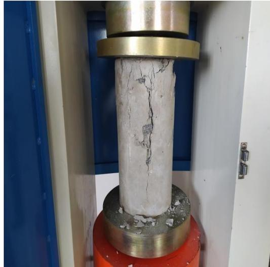
**Gambar 6.** Hasil Pengujian Kuat Tekan Beton
