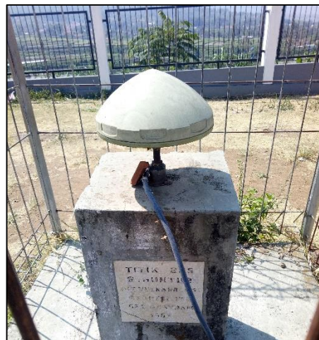
Gambar 2.1 Receiver GNSS Stasiun Pengamatan POST
