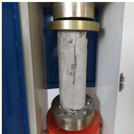
**Gambar 6.** Hasil Pengujian Kuat Tekan Beton
