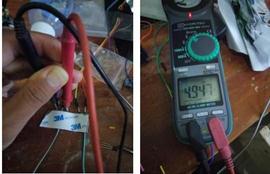
Gambar 4.1.1 Proses Pengukuran Tegangan *Input* (Kiri) dan Hasil Pengukuran Tegangan *Input* (Kanan)
