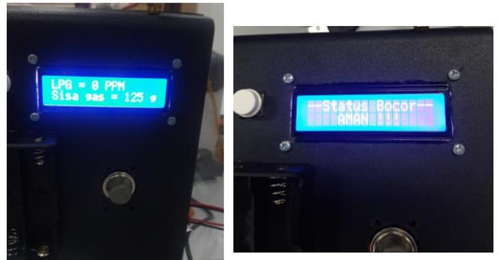
Gambar 10. *Smartbox* LITECTOR menampilkan informasi kadar gas LPG, sisa gas dalam tabung LPG dan status kebocoran.
