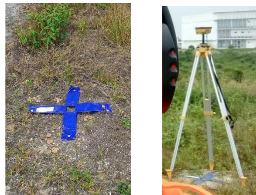
Gambar 6 . Survei GPS untuk GCP dan ICP
