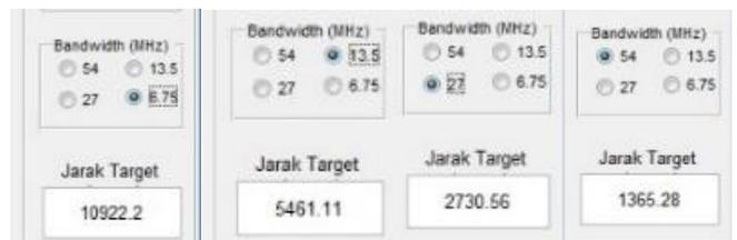
**Gambar 17 – Pengujian pada Frekuensi 500 kHz pada Bandwidth 6,75, 13,5, 27, dan 54 MHz**
