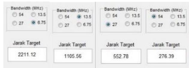
**Gambar 15 – Pengujian pada Frekuensi 100 kHz pada Bandwidth 6,75, 13,5, 27, dan 54 MHz**
