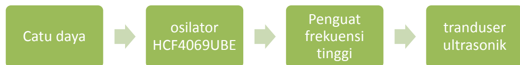
Gambar 3.1. Blok diagram rangkaian alat pembangkit gelombang ultrasonik
