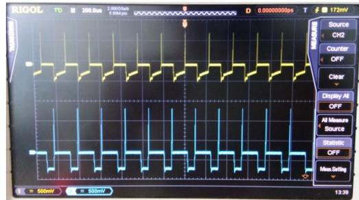
Gambar 10. *Output* Sinyal dari Switching Mosfet.
