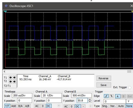
Gambar 6. Sinyal PWM Hasil Penguatan dan Sinyal *Output* dari *Switching Mosfet*.
