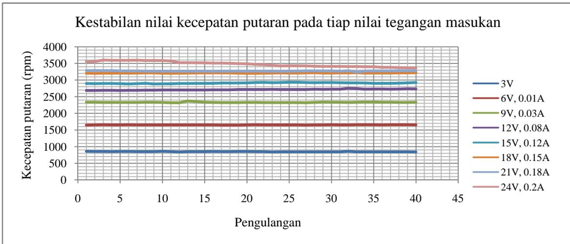
**Gambar 4.7** Grafik kestabilan nilai kecepatan putaran alat *spin coater* pada tiap nilai tegangan masukan dengan durasi pengukuran selama dua menit
