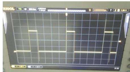
Gambar 12. Osiloskop dengan pembacaan PWM 255
